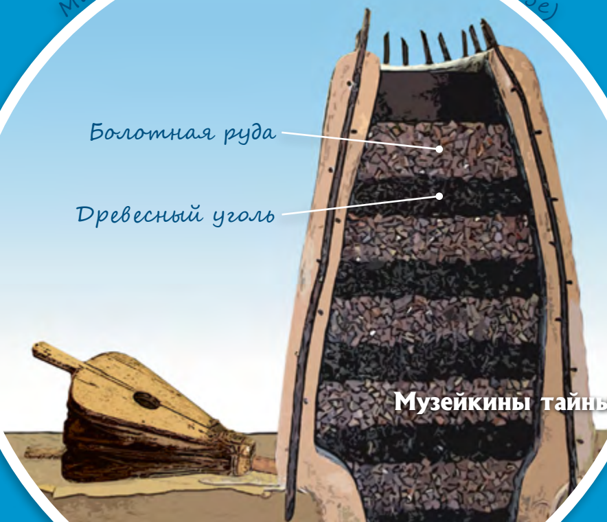
Макет печи для плавки железа (в разрезе)
